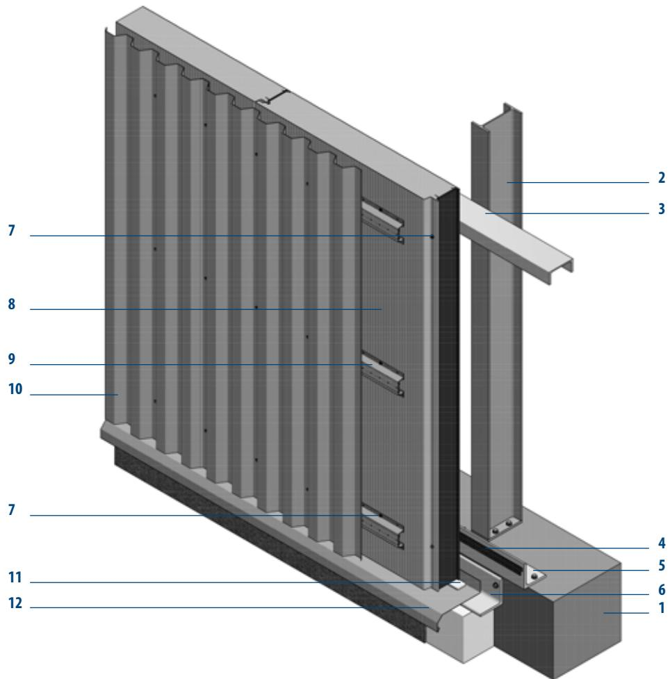
MONTANATHERM® Carrier Wandelemente als Unterkonstruktion. SWISS PANEL® Trapezprofil vertikal auf Distanzkonstruktion verlegt.
