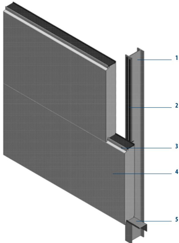
MONTANATHERM® Sandwichelemente horizontal verlegt.
