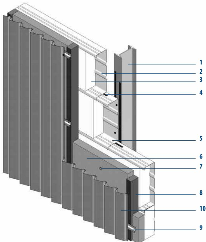
MONTAWALL® Kassetten mit eingelegter Dämzung und Zusatzdämmung. MONTAFORM® Design Bekleidungsprofil vertikal auf Unterkonstruktion verlegt.
