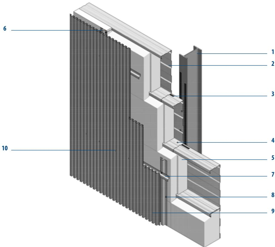
MONTAWALL® Kassetten mit eingelegter Wärmedämmung, Typ LambdaCassette und Distanzbohrschraube. MONTAFORM® Bekleidungsprofil vertikal auf Unterkonstruktion verlegt.
