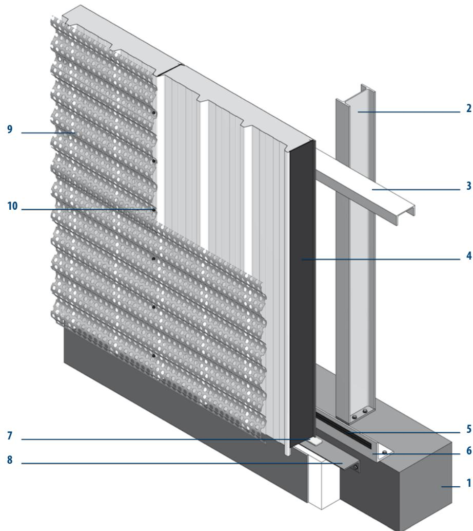
MONTANATHERM® Dachelemente als Unterkonstruktion. SWISS PANEL® Wellbandprofil perforiert horizontal darauf verlegt.
