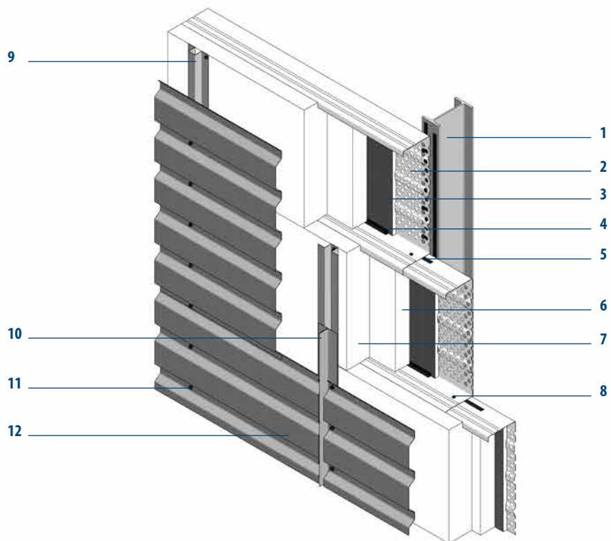
MONTAWALL® Kassetten perforiert mit Akustikdämmplatte, eingelegter Wärmedämmung, Vorsatzdämmung und Distanzschraube. SWISS PANEL® Trapezprofil horizontal auf Unterkonstruktion.
