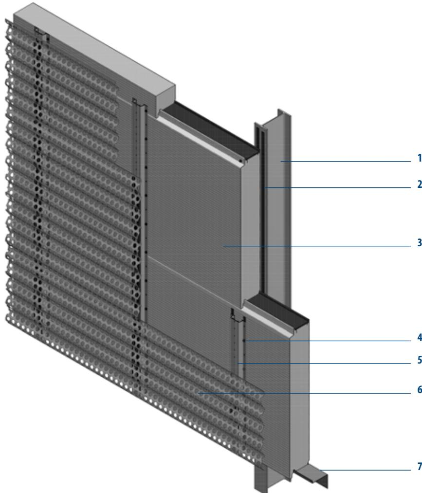
MONTANATHERM® Carrier Wandelemente als Unterkonstruktion. SWISS PANEL® Wellbandprofil perforiert horizontal auf Distanzkonstruktion verlegt.
