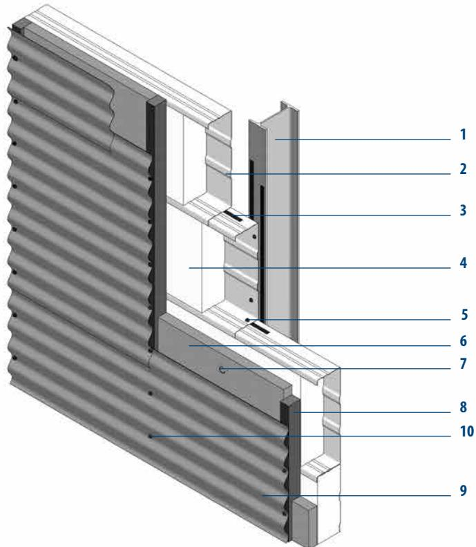
MONTAWALL® Kassetten mit eingelegter Dämmung und Zusatzdämmung. SWISS PANEL® Wellbandprofil horizontal auf Distanzlattung verlegt.
