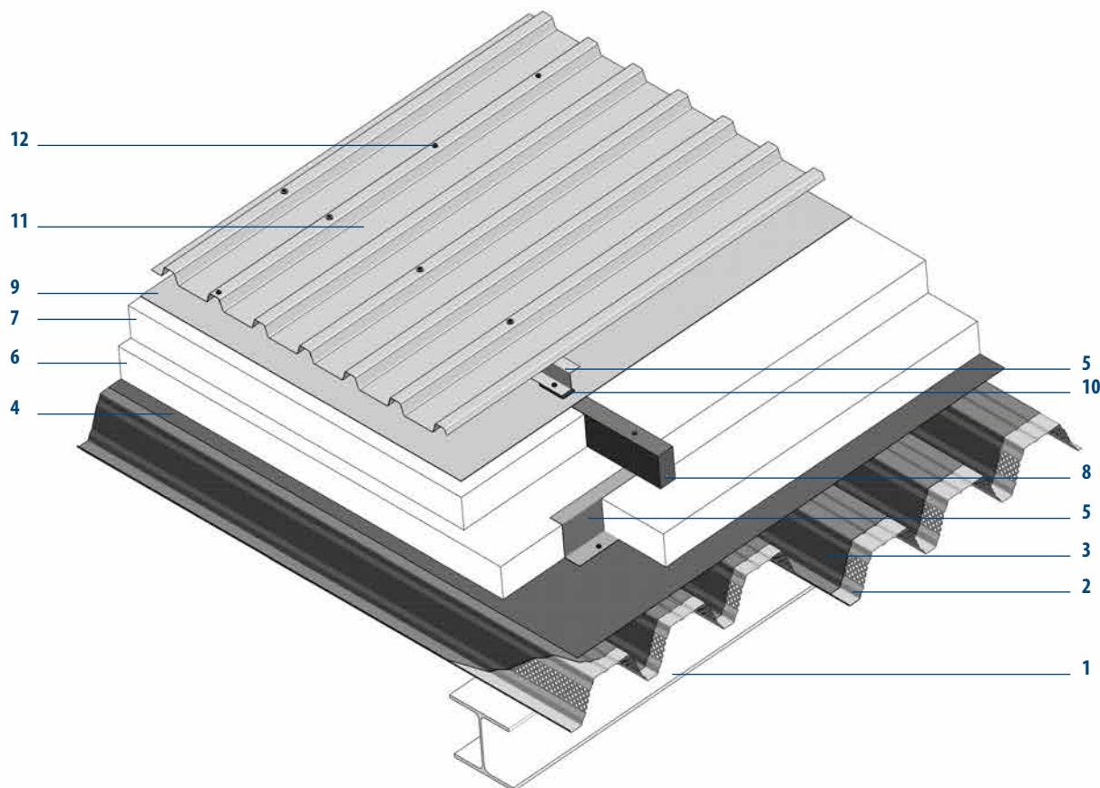
SWISS PANEL® Trapezprofile perforiert mit Akustikvlies innen und SWISS PANEL® Trapezprofile aussen. Mit Wärmedämmung und Unterdachbahn.
