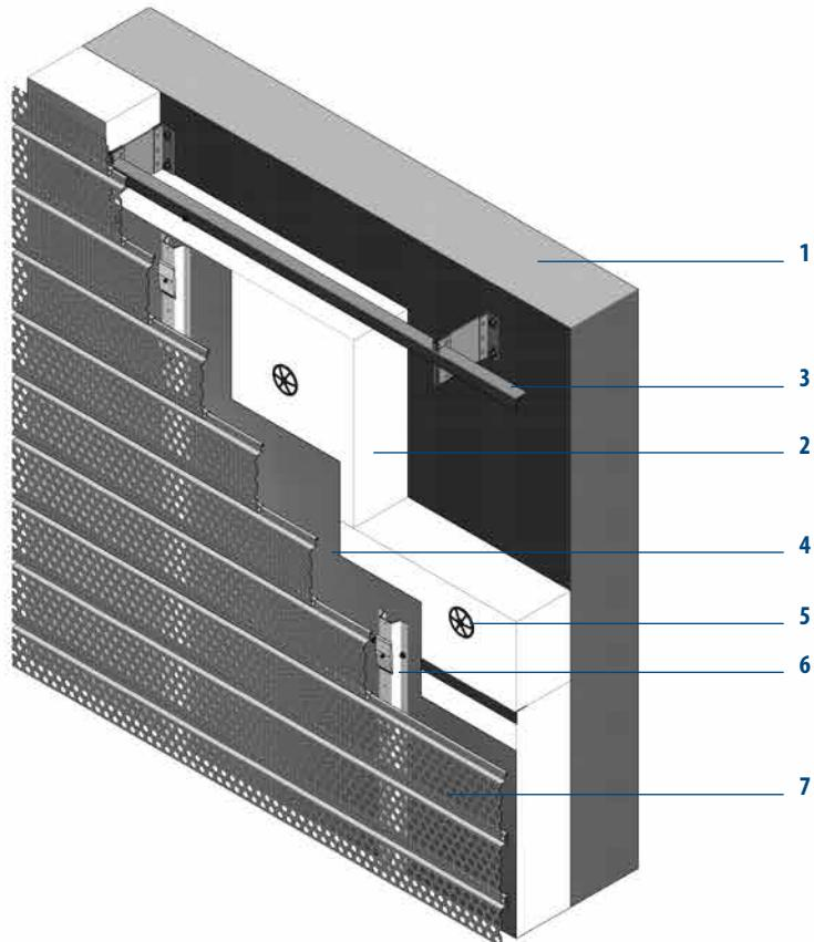
Betonwand mit aufgesetzter Dämmung und perforierten MONTALINE® Bekleidungsprofilen horizontal auf MONTAFIX® Unterkonstruktion verlegt.
