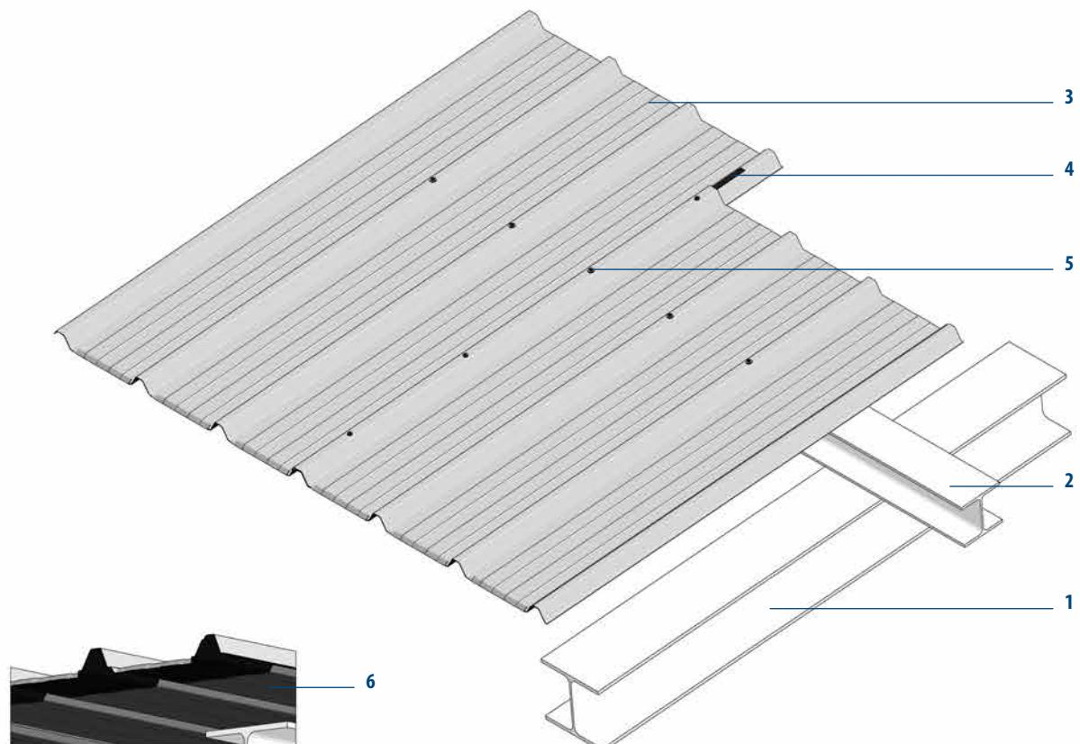
SWISS PANEL® Trapezprofile mit Antikondensatvlies.
