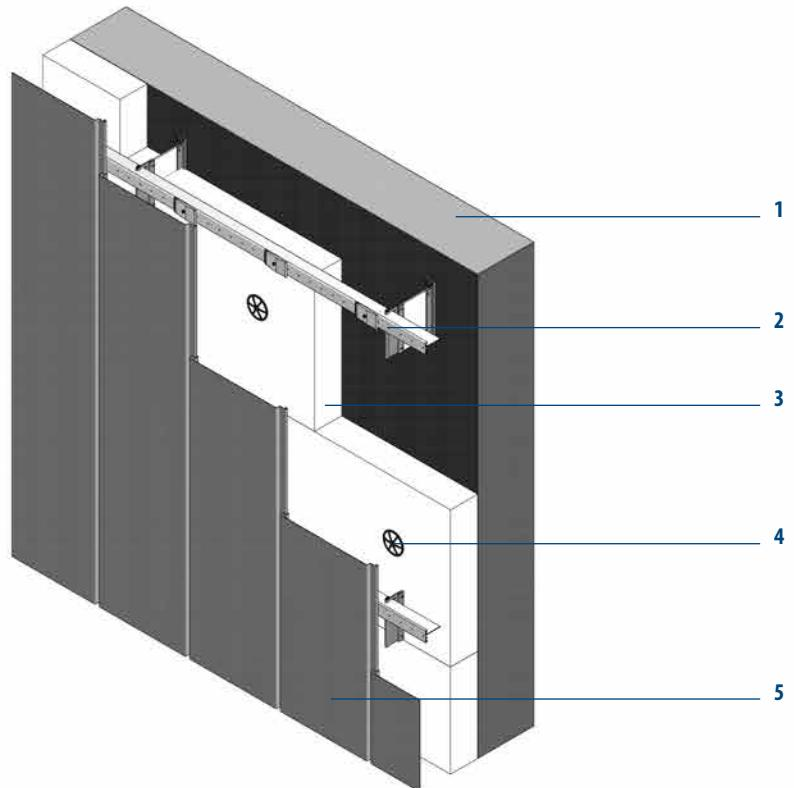
Betonwand mit aufgesetzter Dämmung und MONTALINE® Bekleidungsprofil vertikal auf MONTAFIX® Unterkonstruktion verlegt.
