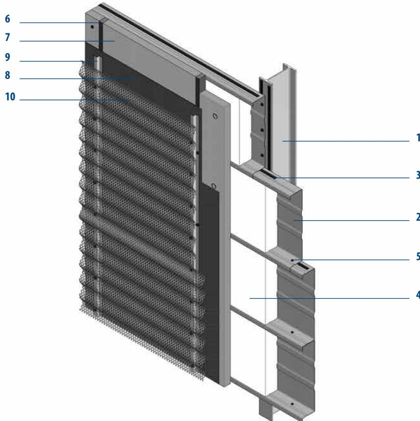
MONTAWALL® Kassetten mit eingelegter Wärmedämmung und einer Fassadenbahn. SWISS PANEL® Wellbandprofil perforiert horizontal auf Unterkonstruktion verlegt.
