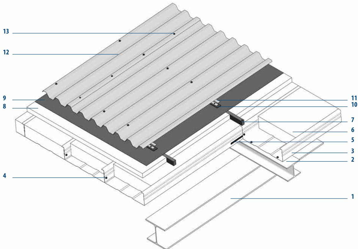
MONTAWALL® Kassetten innen und SWISS PANEL® Trapezprofile aussen. Mit Wärmedämmung und Unterdachbahn.
