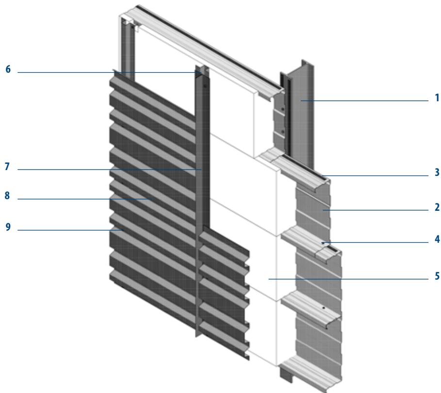
MONTAWALL® Kassetten mit eingelegter Dämung und Distanzbohrschiene. MONTAFORM® Bekleidungsprofil horizontal auf Unterkonstruktion verlegt.
