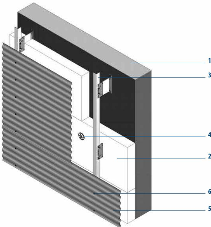
Betonwand mit aufgesetzter Dämmung, Unterkonstruktion und SWISS PANEL® Wellprofil horizontal verlegt.
