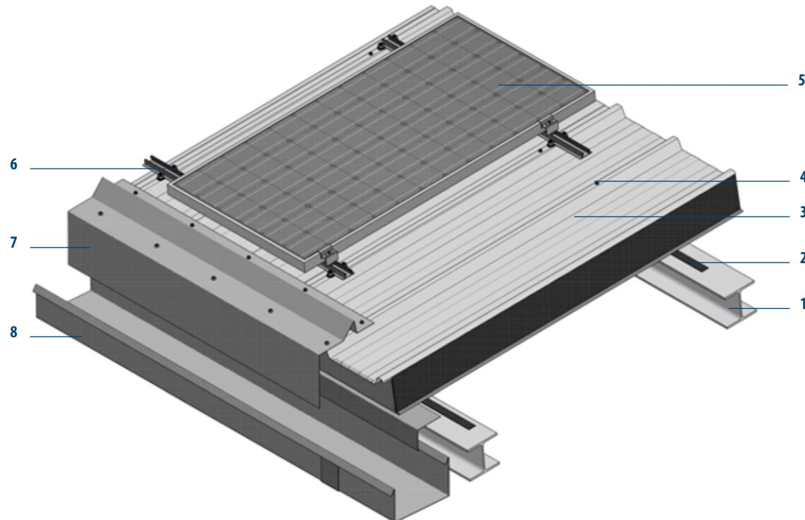
MONTANATHERM® Sandwichelemente mit Photovoltaik-Elementen, Schneefang und Dachrinne.
