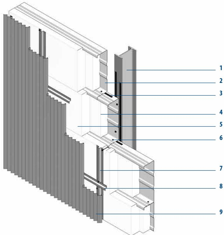
MONTAWALL® Kassetten mit eingelegter Wärmedämmung, Vorsatzdämmung und Distanzschraube. MONTAFORM® Design Bekleidungsprofil vertikal auf Unterkonstruktion verlegt.
