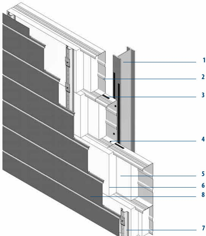
MONTAWALL® Kassetten mit eingelegter Wärmedämmung. MONTALINE® Bekleidungsprofil horizontal auf MONTAFIX® Unterkonstruktion verlegt.
