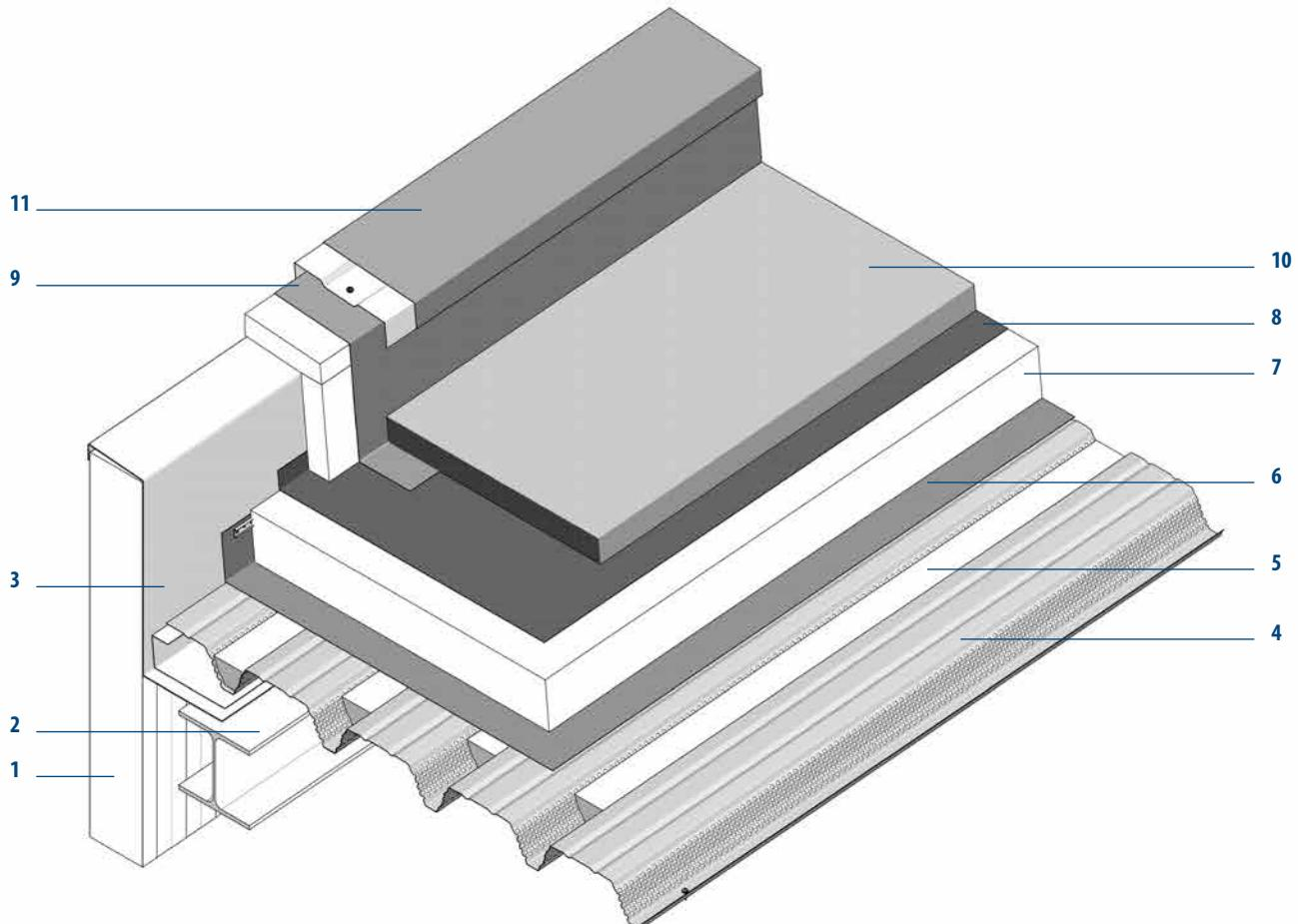
SWISS PANEL® Trapezprofile perforiert mit Akustikeinlagen, Wärmedämmung und Dachabdichtung.
