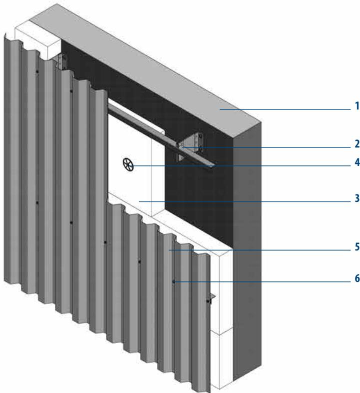
Betonwand mit aufgesetzter Dämmung, Unterkonstruktion und SWISS PANEL® Trapezprofil vertikal verlegt.
