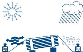
Lorsque les profils ne sont pas utilisés immédiatement, il est conseillé de les couvrir de bâches naturelles aérées (pas de film plastique).
