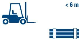
Bei kurzen Paketen bis 6 m kann das An- oder Abheben auch mittels Stapler sachgemäss und mit geschützten Gabeln (z. B. mit gummierten Auflagen) erfolgen. Ausgenommen sind vliesbeschichtete Profilbleche, welche nur mit Hebegurten angehoben werden dürfen.
