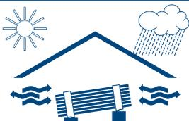
Für die Lagerung der Bauteile muss eine geeignete Lagerfläche zur Verfügung stehen. Die Pakete müssen auf der Baustelle trocken und mit leichtem Gefälle in Längsrichtung gelagert werden, damit Regenwasser abfließen kann.
