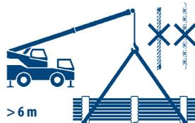
Der Ablad, das Handling oder der Umschlag auf der Baustelle sollen zum Schutz der organischen Beschichtungen sowie der Vliesbeschichtungen nur mit Hebegurten erfolgen.
