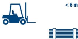
Bei kurzen Paketen bis 6 m kann das An- oder Abheben auch mittels Stapler sachgemäß und mit geschützten Gabeln (z.B. mit gummierten Auflagen) erfolgen. Ausgenommen sind vliesbeschichtete Profilbleche, welche nur mit Hebegurten angehoben werden dürfen.
