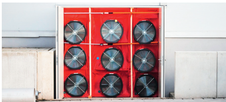
Bild 6: Blower-Door-Gebläse, eingebaut in einer Gebäudehülle aus Sandwichelementen: blower-door-international.de
