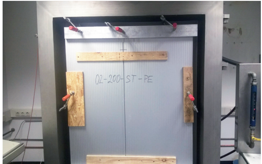
Bild 4: Sandwichelement eingebaut im Laborprüfstand
