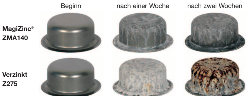
Der Salzsprühnebelprüfung ist ein azyklischer Test, bei dem ein Nebel aus 5 % NaCl in 35° C warmem Wasser erzeugt wird. Dieser Test wird gemäß EN 13523-8 (ASTM 8117) durchgeführt.
