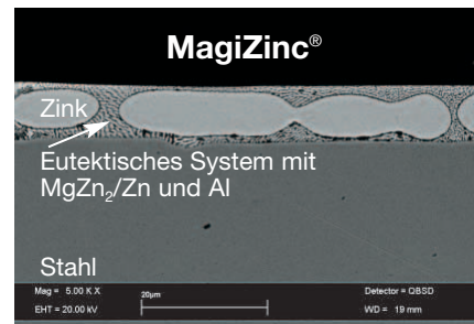
Mikroskopische Aufnahme eines Querschnitts aus dem mit MagiZinc® beschichteten Stahl.
